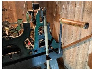
Für maximal 28 Stunden bewegt die Mechanik die Zeiger der Uhr am Kirchturm und sorgt durch eine ausgeklügelte Technik dafür, dass zu jeder halben und vollen Stunde ein
